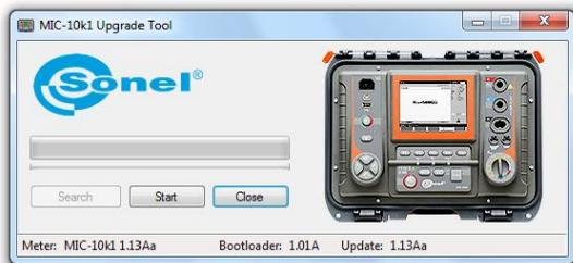
5. Nach der Aktualisierung trennen Sie das Messgerät vom Computer und klicken Sie auf **Close** (Schließen).
