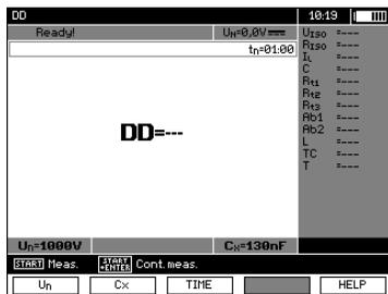
Tasten **F1** **Un**, **F2** **Cx** und **F3** **TIME** verwenden, um die gewünschte Spannung, Kapazität sowie die Prüfzeit, (1...60 Min) des Prüflings einzustellen. Durchführung ähnlich wie in Abschnitt 3.2.2.
